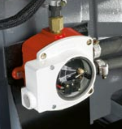
Enchimento automático de óleo, que prolonga os intervalos de assistência
